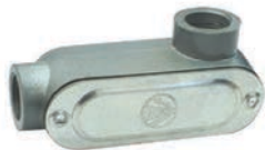
CONDULETS Caja de paso ovalada con tapa atornillada y junta de goma sintética, con disposición de vías C, L, LL, LR, T, X y LB con rosas de 1/2" hasta 4" NPT.
