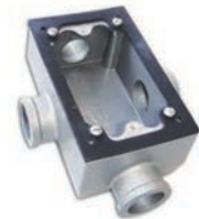
AFS Caja rectangular con tapa atornillada para interruptores, tomas y pulsadores con disposición de vías E, C, L, T y X con rosas de 5/8" hasta 1" BSC y 1/2"-3/4" NPT.
