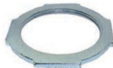
THZ Contratuerca de hierro zincado para fijación del lado exterior de la caja. Para caños con rosca de 5/8" hasta 2" BSC, de 1/2" hasta 6" BSPT y de 2 1/2" hasta 6" NPT.
