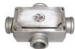
RC Caja rectangular con tapa atornillada, con disposición de vías C, L, T y X con rosas de 5/8" hasta 1 1/4" BSC y de 1/2" hasta 1" BSPT.
